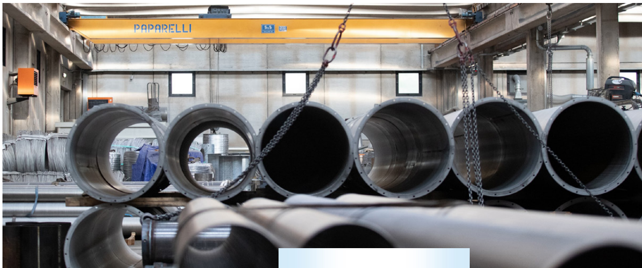
Paparelli è in grado di fornire tubi con unica saldatura longitudinale a piena penetrazione mediante processo Tig/Plasma (Paw) in lunghezze fino a 12 m
