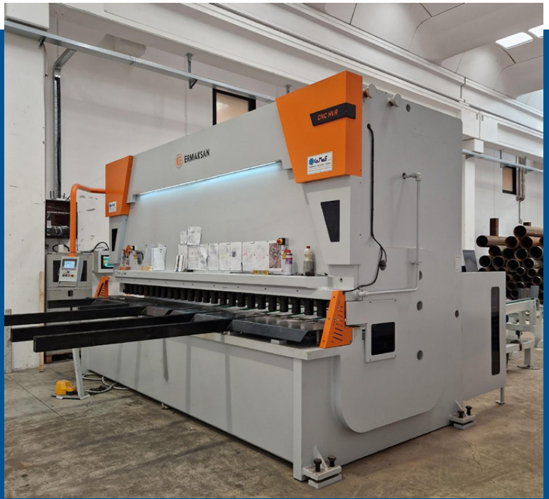
Fornita a Paparelli da Co.Ma.F. la cesoia ad angolo variabile a Cnc Ermaksan HVR 4100-25 assicura una lunghezza utile di taglio fino a 4.100 mm, e capacità di lavorare spessori fino a 25 mm
