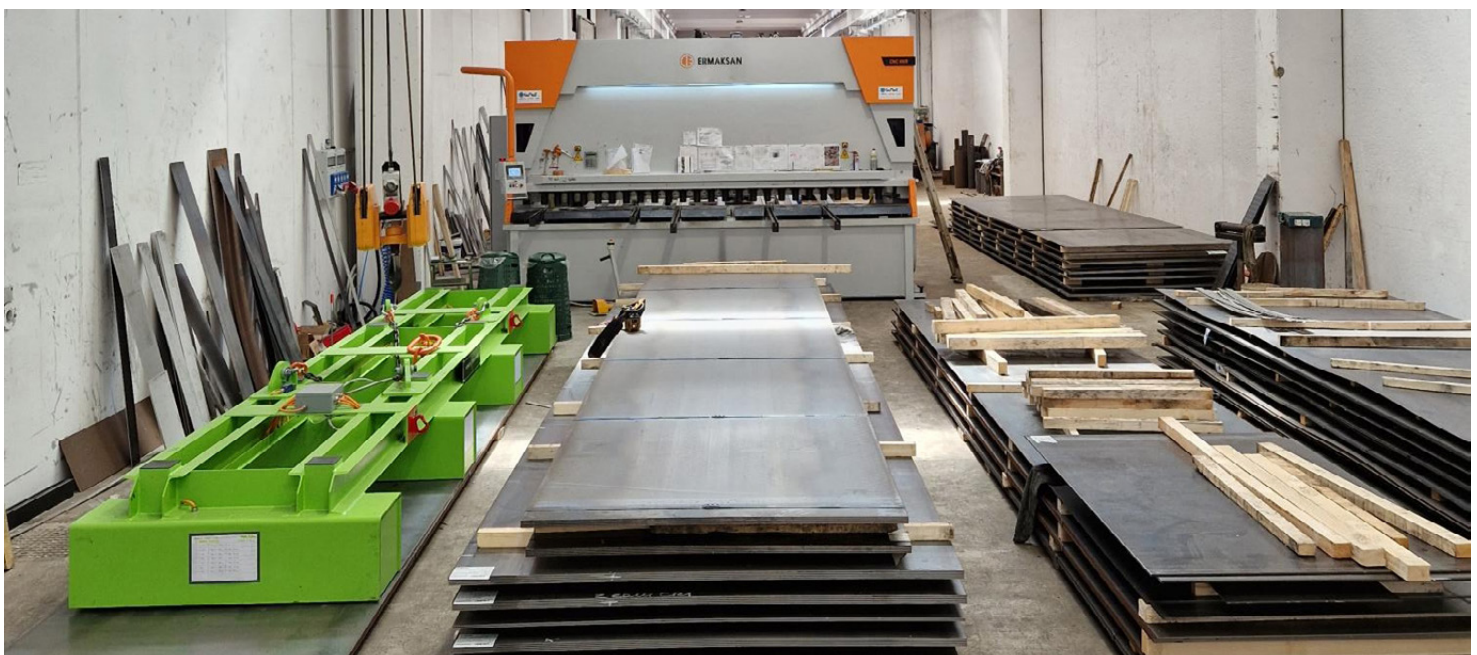
Vista della nuova cesoia idraulica a Cnc ad angolo variabile Ermaksan HVR 4100-25, fornita e installata presso la Paparelli di Carimate (CO) da Co.Ma.F. di Sovico (MB)
